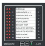
**M1000 ALARM MONITOR :** Le M1000 est un panneau de report d'alarme à 10 entrées logiques, il offre la possibilité d'afficher une LED d'indication sur un panneau personnalisable, d'activer une sirène d'alarme et une sortie logique, le tout paramétrable avec un délai et un reset dédié pour chaque entrée. Le M1000 est configurable par ordinateur via un port RS232 et possède une sortie RS 485 dédiée à la supervision en MODBUS-RTU.
