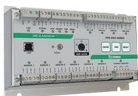
La gamme de protection par détection d'arc électrique permet de sécuriser les armoires de puissance grâce à une série de capteurs lumineux calibrés pour interpréter les arcs à l'intérieur d'une installation, d'un jeu de barre ou d'un coffret, ces boîtiers montés sur rail DIN peuvent être multipliés et assemblés avec d'autres boîtiers de protection de court-circuit.
